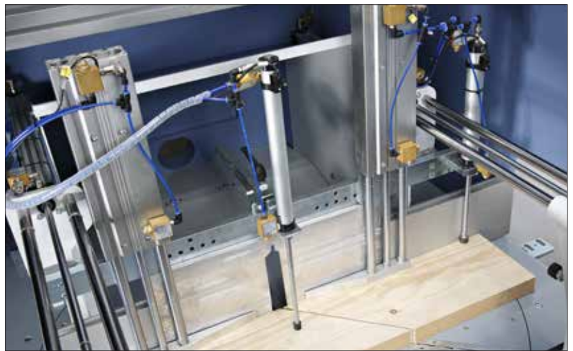
Nr. 4 Teste di stampa in verticale, altezza di stampa mm. 50,8
